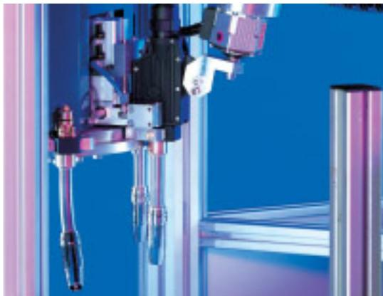
**5** Der Austausch-Wechselhals wird in den Wechselkörper eingesetzt. Alle Versorgungsanschlüsse sind automatisch angeschlossen. Der Roboter bewegt den WH-Schweißbrenner aus der Wechselstation und nimmt die Schweißstätigkeit wieder auf.
