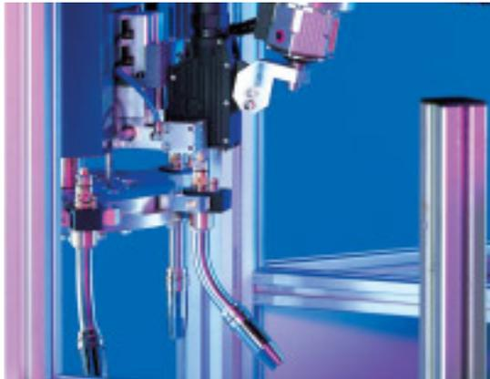
**3** Durch die Abwärtsbewegung der Rotorplatte wird der Wechselhals entnommen. Schnellverschlüsse in den Versorgungskanälen verhindern den Austritt von Kühlmittel.
