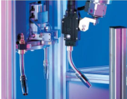
**1** Der Roboter positioniert den WH-Schweißbrenner in der Wechselstation.
