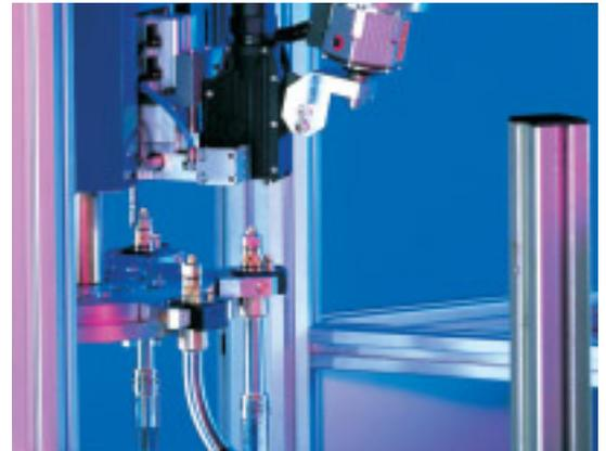
**4** Der ATS-Rotor positioniert einen Austausch-Wechselhals unter die Wechselstation.
