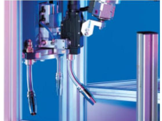
**2** Der Wechselhals wird entriegelt. Zeitgleich wird der Draht im Wechselkörper abgeschnitten.
